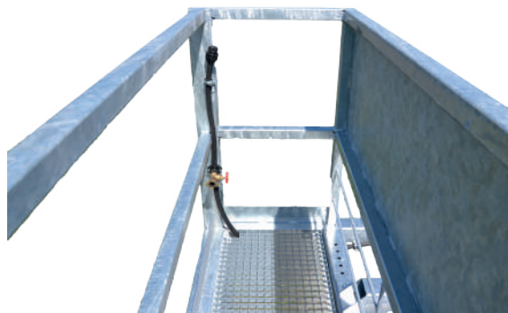
Circuit d'eau avec vanne et raccord type pompier
